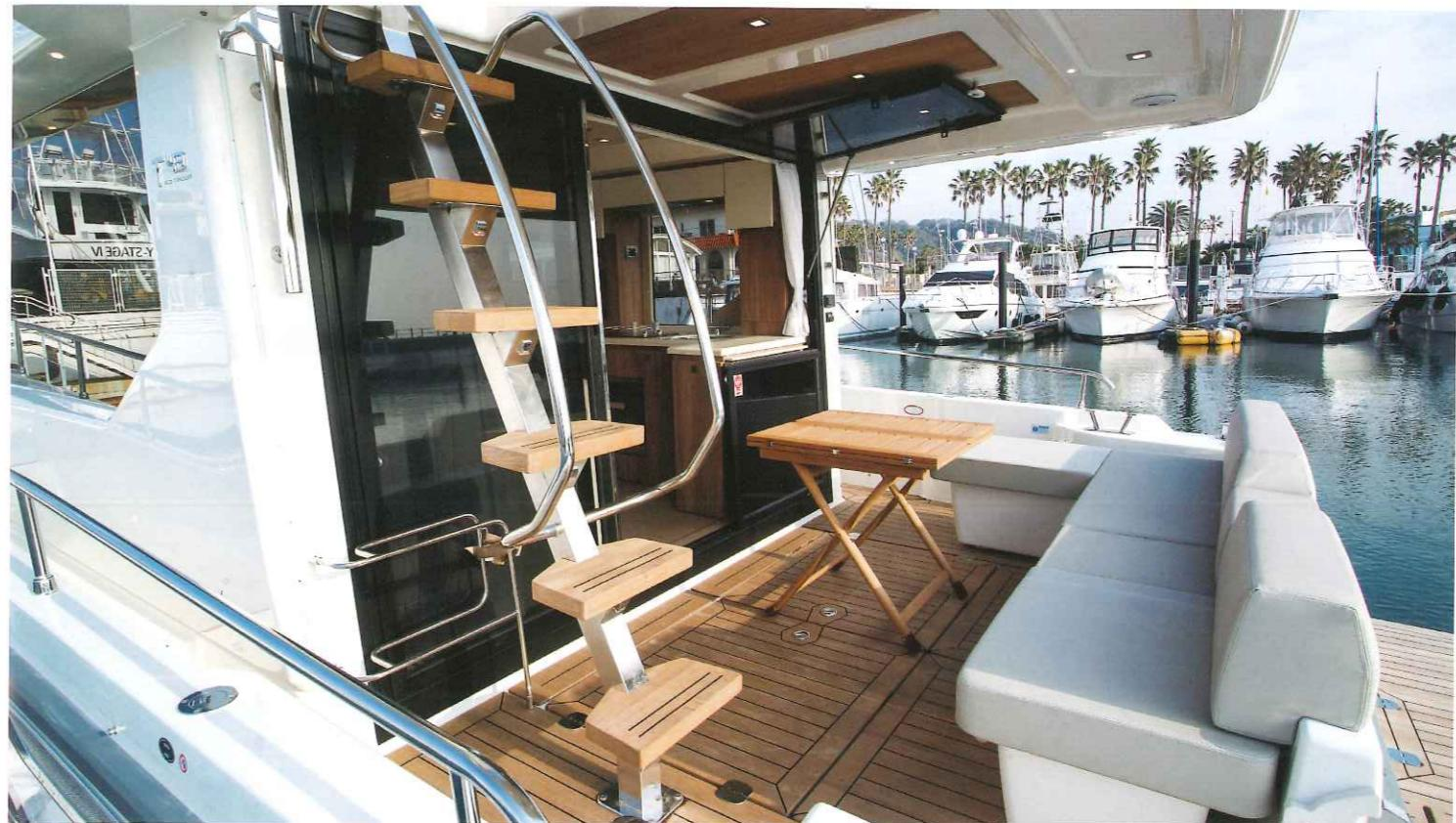
航路を出てスロットルを倒し加速する。エンジン音、排気音は静か、振動もフライブリッジではほとんど感じられない。風切り音や波の音にかき消される程だ。艇速は1,000回転で5.2ノット、2,000回転では8.6ノット。この時の消費燃料は36L/h。トルク感はないが、ハンドルもせず、抵抗の少ないボトムデザインにより加速はスムーズ。柔らかく心地よい走り。ふわふわした浮遊感やソフトな波当たりは他には無い感覚。2,500回転で10.6ノット。3,000回転で13.8ノット。3,000～3,200回転 15～16ノットが通常のクルージングスピード。そして、MAXは3,500回転で21.5ノットを記
