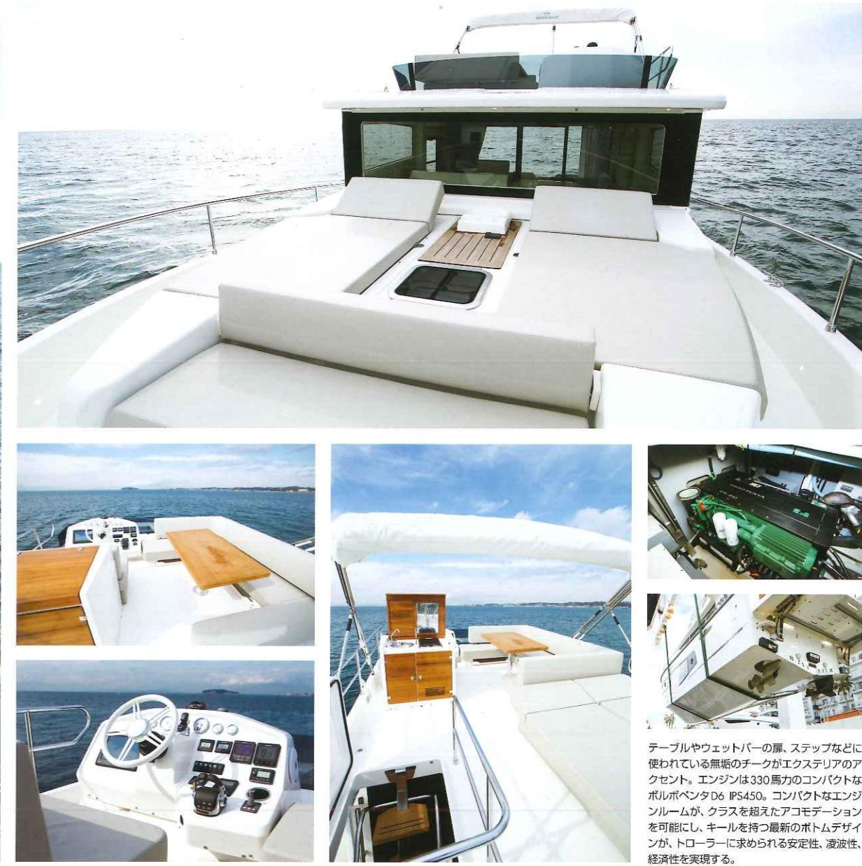
テーブルやウェットバーの扉、ステップなどに使われている無垢のチークがエクステリアのアクセント。エンジンは330馬力のコンパクトなボルボペンタD6 IPS450。コンパクトなエンジンルームが、クラスを超えたアコモデーションを可能にし、キールを持つ最新のボトムデザインが、トローラーに求められる安定性、凌波性、経済性を実現する。
