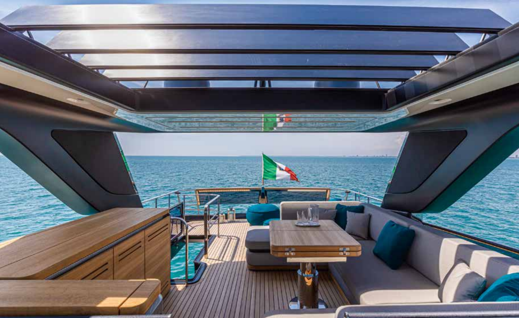
Tトップに搭載されたサンルーフは世界的トレンドのルーバータイプ。完全に閉じることで雨を防ぎ、開けた加減で光量を調整することができる。また、風はフライブリッジに流れるが、ハードタイプなので強風時でもバタつくことはない。
