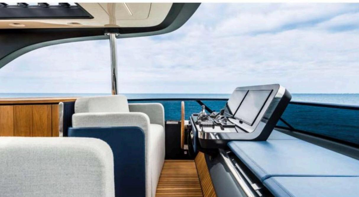
La plancia è dotata di schermi Garmin, che permettono di controllare i motori, la navigazione e il sistema domotico basato sulla tecnologia Empirbus, che controlla tutte le utenze e le funzioni della barca da qualsiasi monitor dell'unità, compreso quello che si trova nella cabina del comandante.
