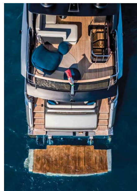
Hydraulicky ovládaná koupací plošina usnadňuje vstup do vody při koupání a pomáhá při nakládání pomocného člunu nebo vodního skútru.
