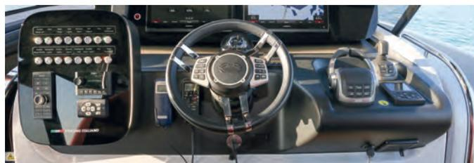
**Ergonomischer Fahrstand mit Multifunktions-Lenkrad und separatem Bedienfeld für die Bordtechnik.**
