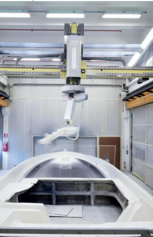
Ci sono vari robot di ultima generazione per la verniciatura e per lo spruzzo della resina.
