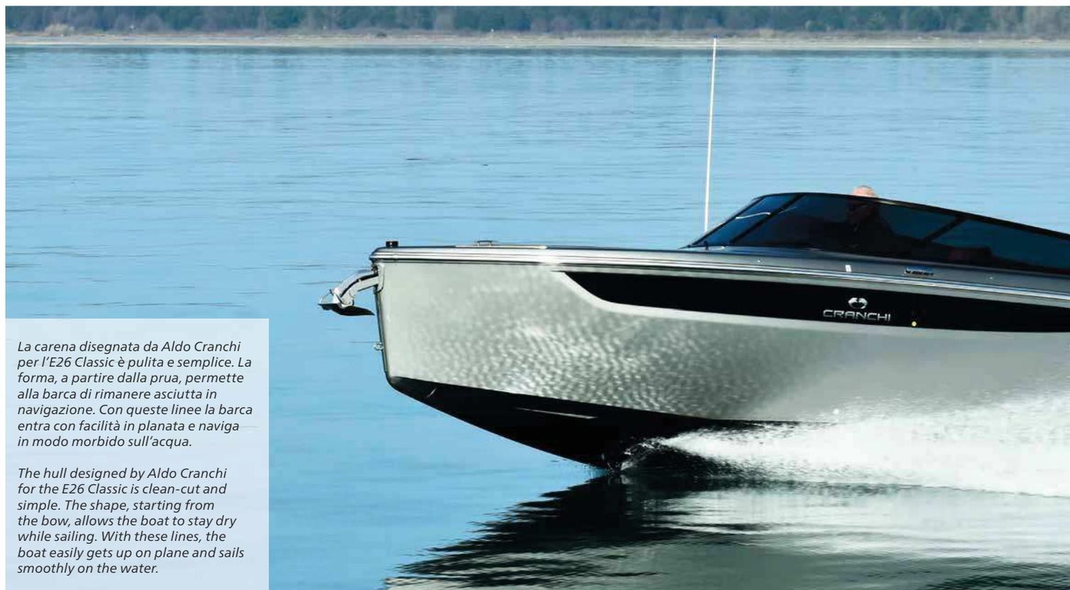
*La carena disegnata da Aldo Cranchi per l'E26 Classic è pulita e semplice. La forma, a partire dalla prua, permette alla barca di rimanere asciutta in navigazione. Con queste linee la barca entra con facilità in planata e naviga in modo morbido sull'acqua.*
